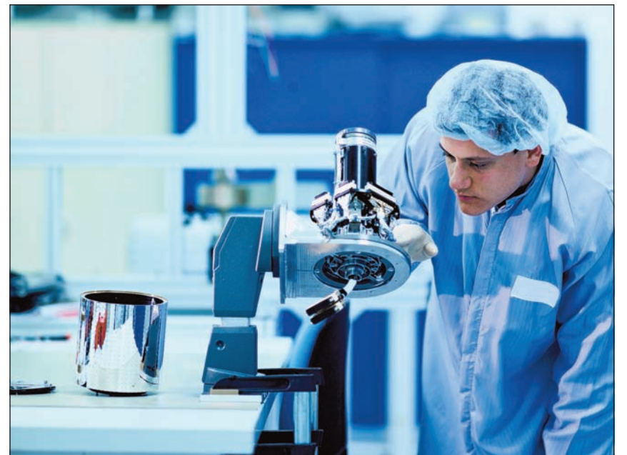
Montage eines Ausrichtmechanismus für die Galileo-Solargeneratoren bei RUAG Space in Zürich. (Bild: RUAG Space)
